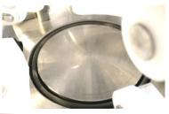
罐定位和顶罐托盘的优化设计(采用平板方式,没有任何缝隙),清理维护更为方便,且封罐的过程中避免损坏罐子
